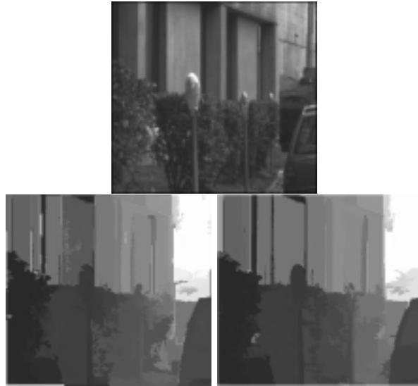
Figura 5: Ejemplo parking meter del conjunto de test JISCT [5]. Imagen de referencia, y resultados con el algoritmo anterior (izquierda) y el nuevo (derecha).
